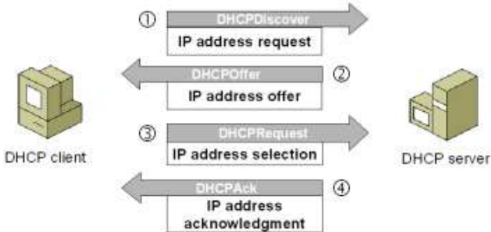
Figura 5: Esquema del funcionamiento del servicio DHCP
