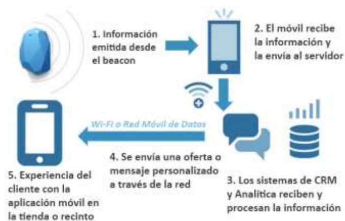
Figura 7. Funcionamiento de la tecnología de geo-localización Beacon
